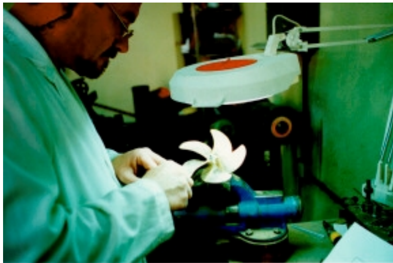
Figura 6.- Construcción del modelo de una hélice
